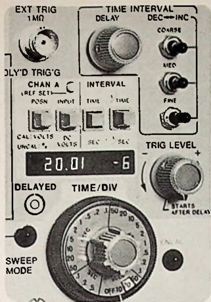
Afb. 10. Bedieningsgedeelte op de hp 1722 A voor de „dual-delayed sweep“. Midden boven de knop voor instelling van het tijdsinterval-begintpunt, rechtsboven de drie knopjes voor het eindpunt. In het midden een LED-indicator, waarop de meetuitkomsten van de microprocessor verschijnen.
